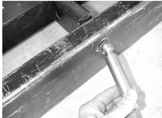
(iv) Insert locator pin
