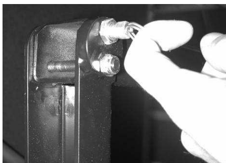
(5) Débloquer le bras pivotant à l'aide de la goupille.
