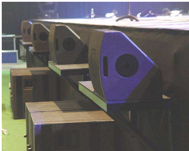
FIGURE 26: EXEMPLE DE SYSTÈME DISTRIBUÉ « NEZ DE SCÈNE » EN I12XT
